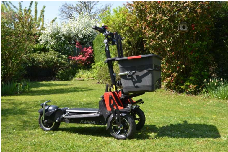
Caisse de transport amovible sur porte charge avant
