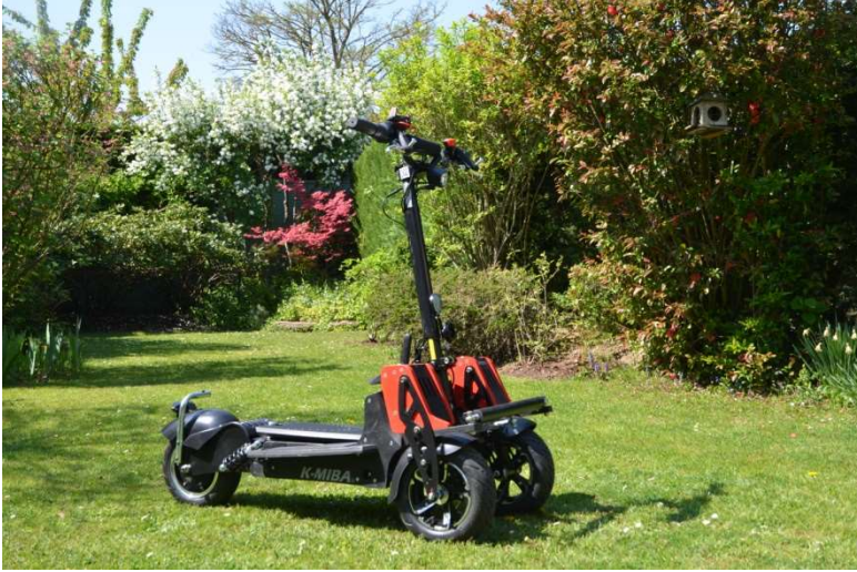
Deux roues avant directrices - Moteur sans balai dans la roue arrière Suspension avant à lames composites - Suspension arrière ressorts hélicoïdaux
